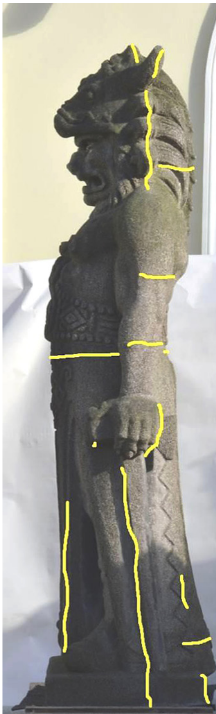
Grafické znázornění trhlin v soše A graphic representation of cracks in the sculpture
