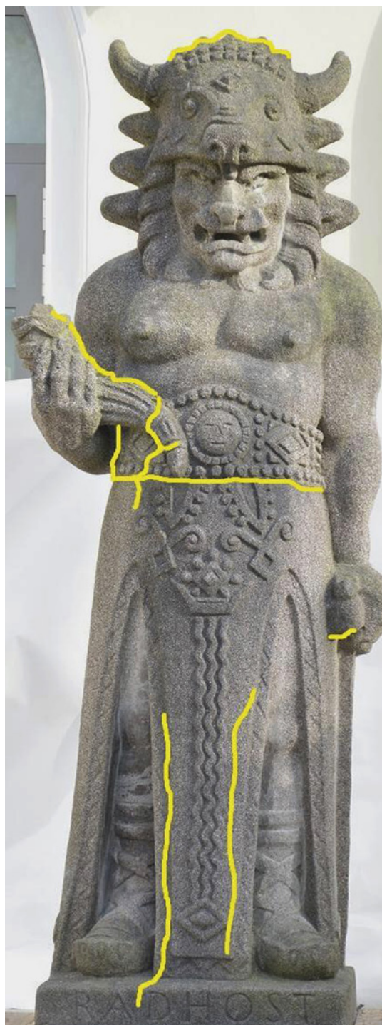
Grafické znázornění trhlin v soše A graphic representation of cracks in the sculpture
